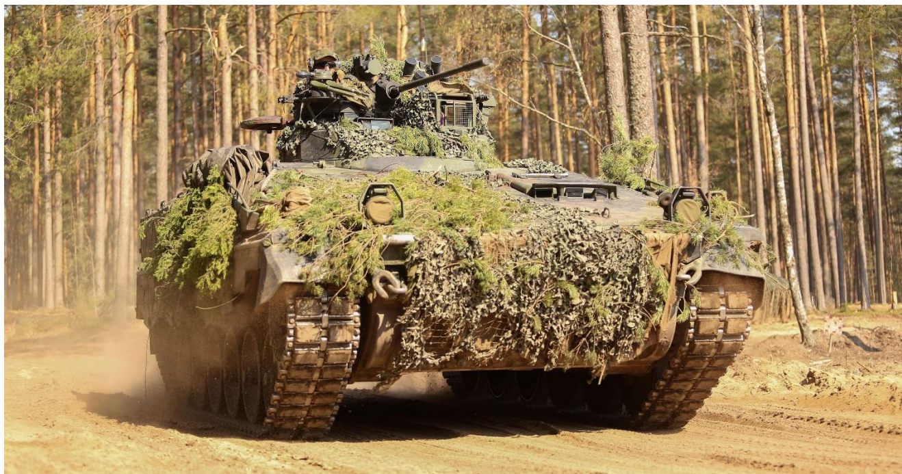
Abb. Schützenpanzer (SPz) vom Typ Rheinmetall Marder 1A5 mit 20-Millimeter-Kanone 58 . Die Besatzung beträgt drei Mann (Kommandant, Fahrer, Richtschütze) sowie sechs Infanteristen für den abgessenen Kampf. 59
