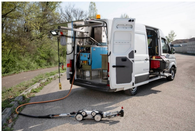
Abb. 4.10 Einsatzwagen und Ausstattung für Robotereinsatz im Kanalnetz
