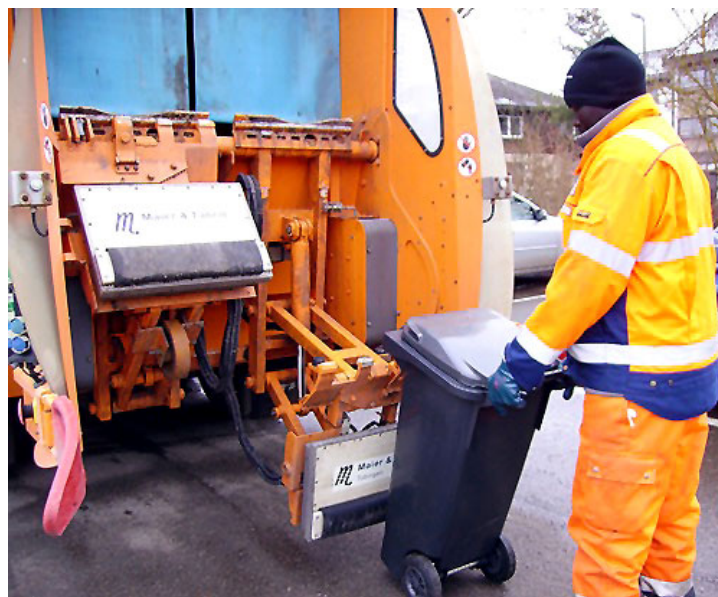
Abb. 3.3 Detektionssystem für Fremdstoffe im Bioabfall
