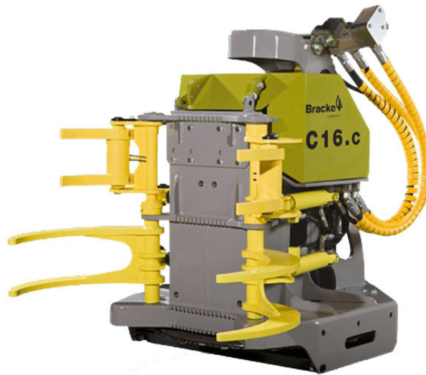
Abb. 4.1 Fäller-Bündler-Aggregat mit doppelten Greiferarmpaaren der schwedischen Firma Bracke Forest
