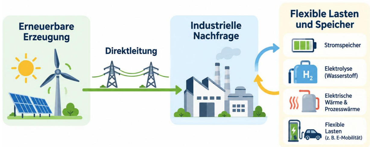
Abbildung 2: Direktbelieferung verbindet erneuerbare Erzeugung mit industrieller Nachfrage, flexiblen Lasten und Speichern.
