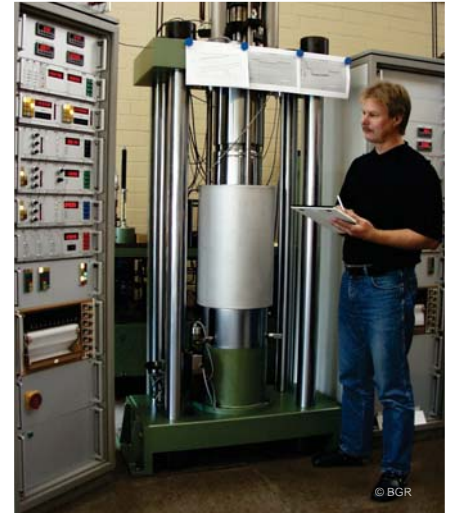
Beheizbare triaxiale Prüfmaschine im gesteinsphysikalischen Labor der BGR
