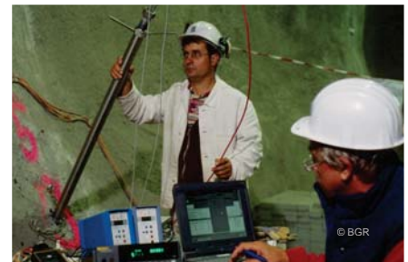
Permeabilitäts-Messungen zur Charakterisierung der Auflockerungszone
