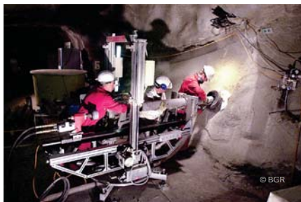
Gebirgsstress-Messungen mit der BGR-Überbohrsonde
