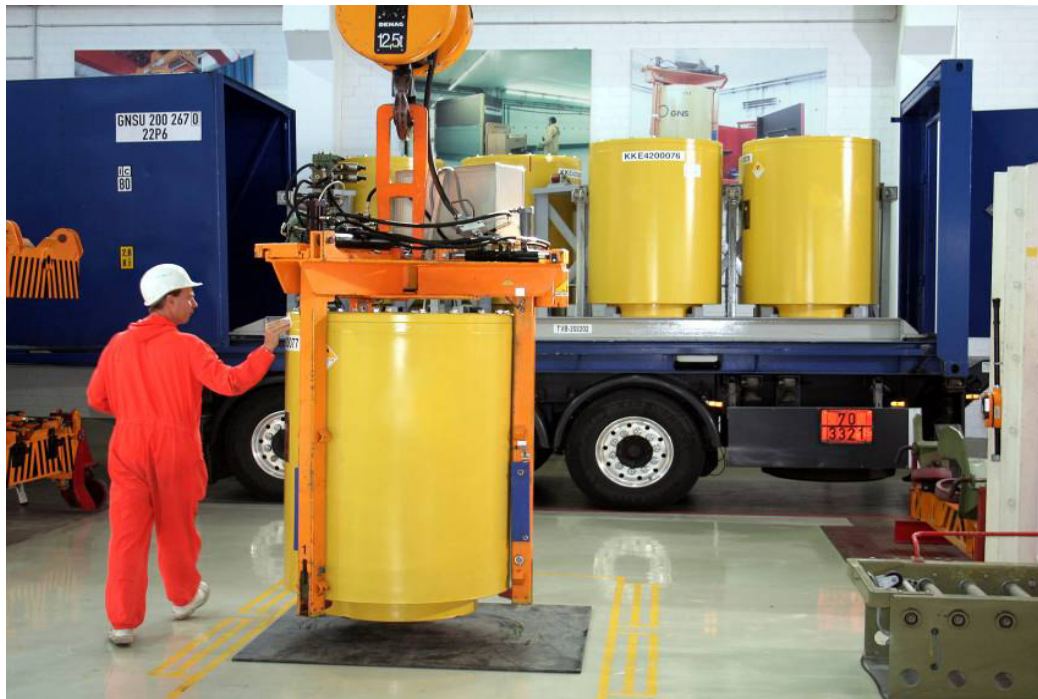
Abbildung F-2: Wischtest zur Produktkontrolle an einem MOSAIK-Behälter (Bildrechte: GNS)
