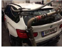
PEMS System von SNF in einem PKW
