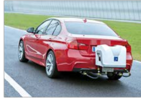
Aktuelles PEMS System für PKW
