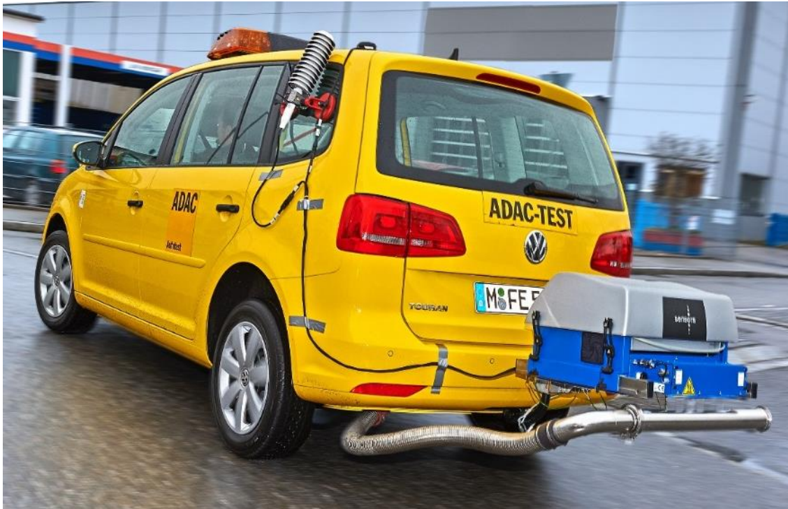
Abbildung 4: PEMS Messgerät für RDE (Real Driving Emissions)
