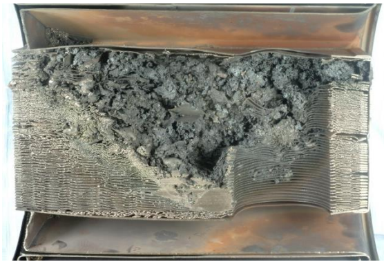
Abbildung 2: Folgen einer unerwünschten Partikelfilterregeneration, DPF - Durchbrand Rußbelastung = 100 [g], T_{\text{Regeneration}} = 650 [^{\circ}\text{C}] [6]
