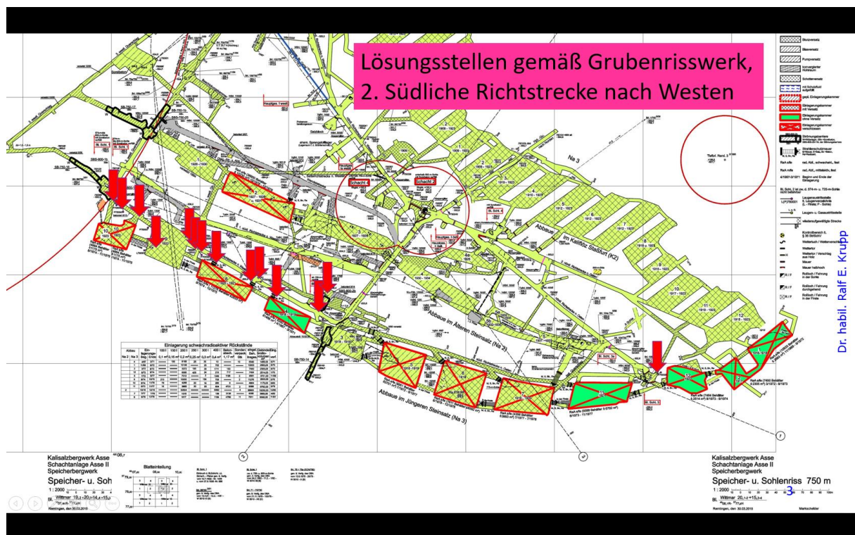
Abbildung 1 – Bekannte Lösungsstellen (rote Pfeile) auf der 2. Südlichen Richtstrecke, 750 m Sohle. Zutrittsmengen derzeit ca. 100 Liter/Tag im Bereich der 2. Südlichen Richtstrecke; ca. 500 L/d auf der gesamten 750 m Sohle. Die Mehrzahl der Lösungsstellen befindet sich in dem jetzt zur Verfüllung anstehenden westlichen Abschnitt der Richtstrecke.
