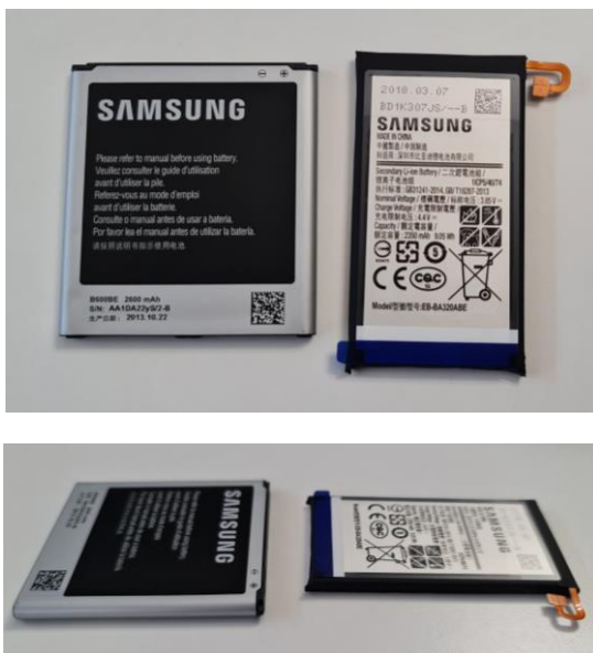
Bild 1+2: Links entnehmbarer Akkumulator (2.600mAh), rechts fest verbauter Akkumulator, der durch einen Stecker mit dem Gerät verbunden wird (2.350mAh)
