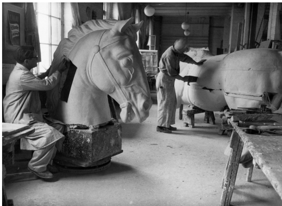
Abb. 2 Gipsformerei 1957, Herstellung der Gipspositive (Foto: Landesdenkmalamt Berlin)
