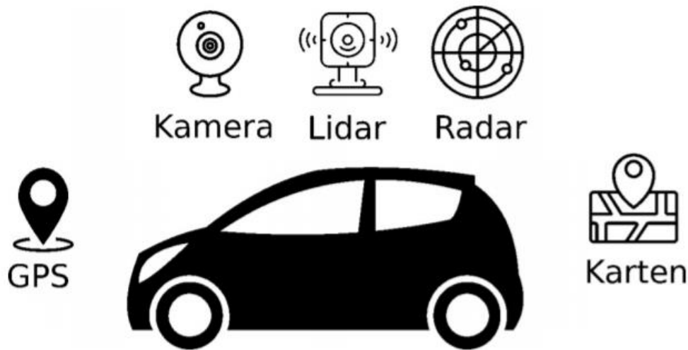
Abbildung 1: Übersicht über die maschinelle Wahrnehmung der Fahrzeugumgebung: Neben Sensoren wie Kamera, Lidar und Radar spielen auch die Standortbestimmung und im Fahrzeug gespeicherte Daten, wie zum Beispiel Karten, eine Rolle.
