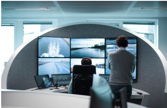
Ein Landbediener navigiert ein Schiff aus dem Landkontrollzentrum in Antwerpen. Die Ansicht entspricht der Steuerhaus- und Fahrstanderweiterungsansicht mit 360-Grad-Kameras und Navigationsunterstützung durch das Ablesen des Computers.
