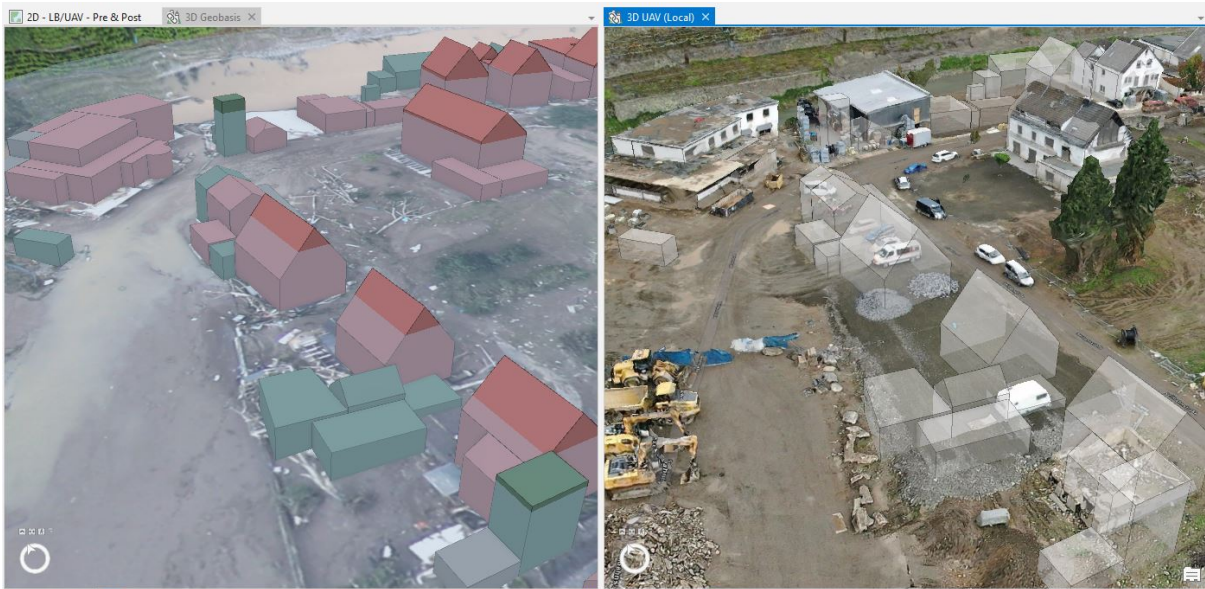
Neue Visualisierungsmöglichkeiten von Kriseninformation zum Hochwasser in Deutschland 2021 – links: Darstellung des behördlichen Gebäudemodells, einer Nachher-Situation mittels Drohnendaten wenige Monate nach dem Hochwasser und des Höchststand des Wassers während des Hochwassers; rechts: Darstellung der Ist-Situation wenige Monate nach dem Hochwasser, einer Nachher-Situation und mit der Einblendung der dort zuvor existierenden Gebäude
